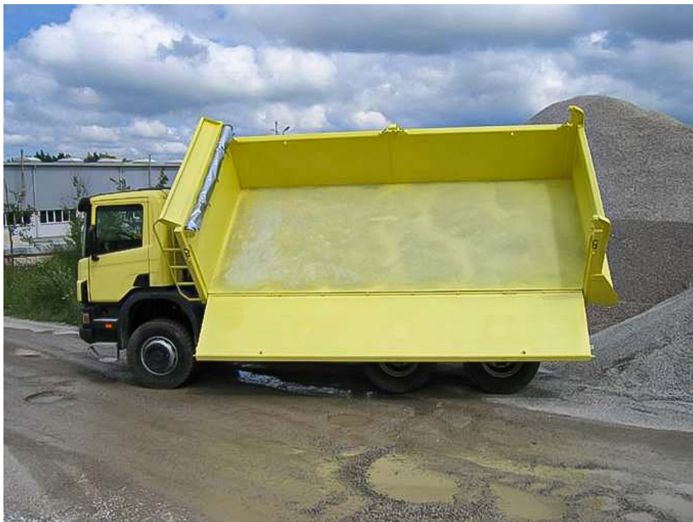
KH-KIPPER prezentuje własnej konstrukcji wywrotkę trójstronną z boczną burtą otwieraną hydraulicznie.
